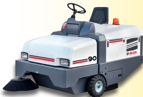
90 EH/BK/DK Elektrisch/LPG/Diesel 9000/13500 m 2 per uur
